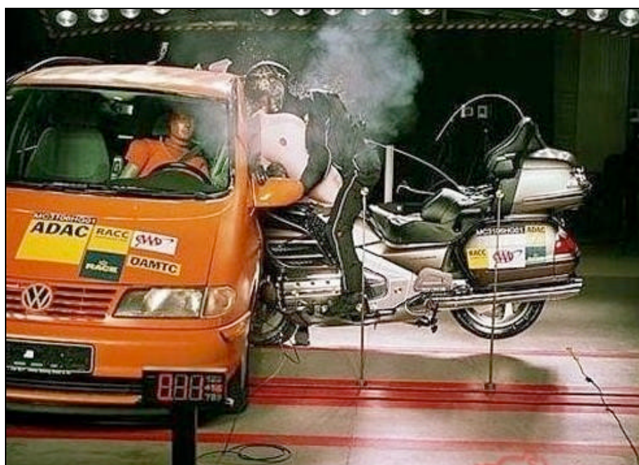
Figura 2 - Crash test dell'Honda Gold Wing con airbag
